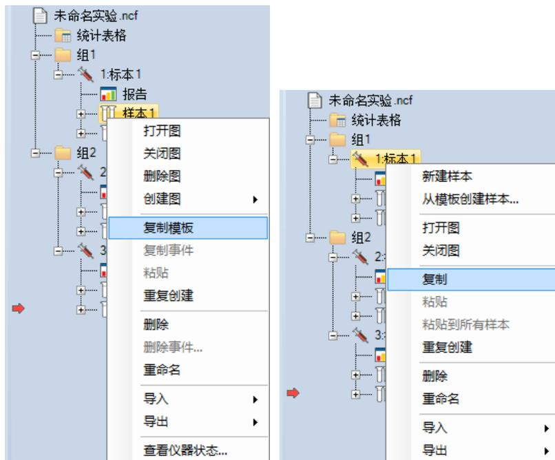
在目标节点右键选择“粘贴”/“粘贴到所有样本”/“粘贴到所有标本”应用模板，如下图：
