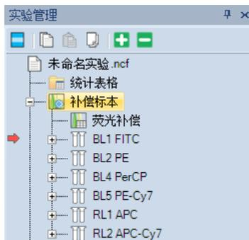
在“实验管理”面板中选择“补偿标本”节点，右键选择“自动补偿设置…”菜单，会打开“自动补偿设置”窗口，可以修改设置，并点击“确定”按钮保存对该自动补偿设置的修改。
