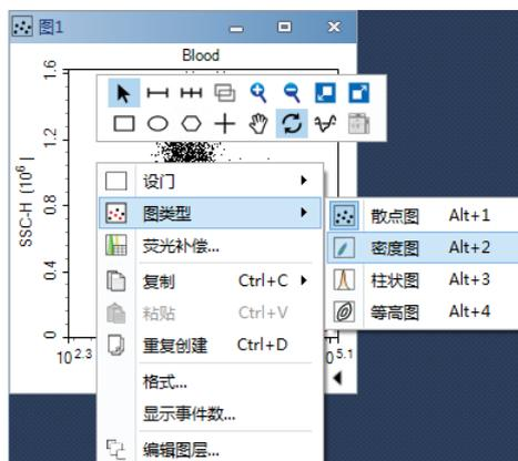
**!** 切换散点图、密度图、等高图等二维图到柱状图时，将删除图上所有的矩形门、椭圆门、多边形门、象限门等二维门。
