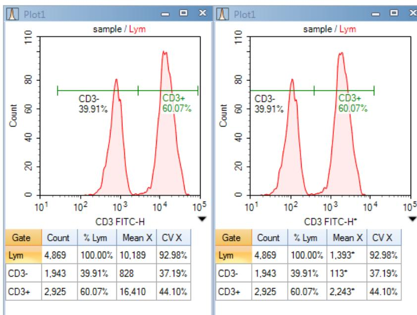
若想要让几个样本的某一参数的峰对齐，可以创建以该参数为X轴坐标的包含这些样本的多图层柱状图，柱状图风格设为平铺，按下鼠标左键拖动图层的柱状图曲线，让这些图层对应峰的位置对齐即可。如下图，左图为虚拟增益前的图，右图为虚拟增益后的图。
