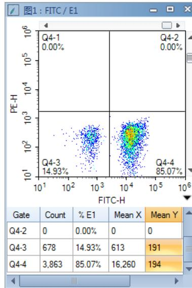
点击滚动条空白区域，可对溢出系数以0.1%的幅度微调，点击滚动条箭头可对溢出系数以0.01%的幅度微调。
