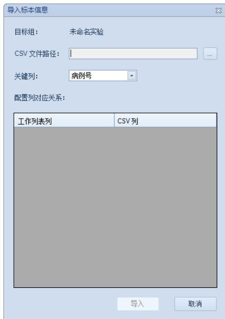
在对话框中选择 CSV 文件路径和关键列，并配置列对应关系，点击“导入”按钮。工作列表会根据关键列创建新标本或更新已有标本信息。若 CSV 文件中某一行的关键列信息在工作列表中的某一标本行已存在，则根据 CSV 文件中该行的信息更新该标本的标本信息，否则将在工作列表中创建一个新的标本行。
