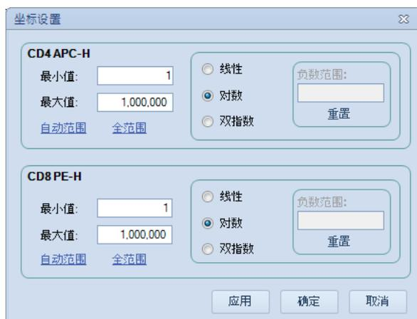
► “图” 菜单：通过“图”菜单设置X轴和Y轴坐标的最小值和最大值。
