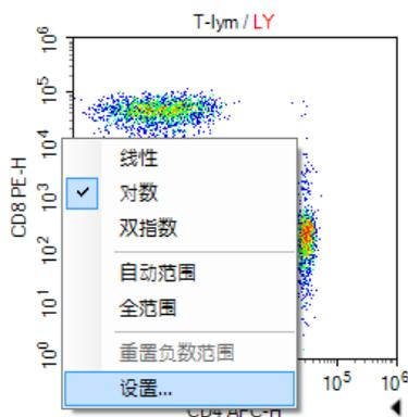
坐标设置对话框中，可手动输入每个坐标的最小值和最大值。
