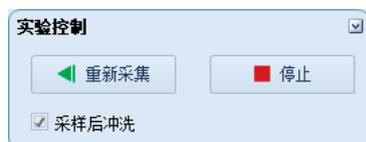
“采样后冲洗”复选框可设置样本采集结束后是否执行样本管路冲洗流程。
