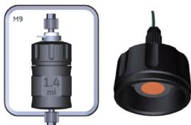
在线过滤膜安装在混合池里面（右图盖子上的黄色区域），换滤膜时，需要先将盖子拧开，换好后再将盖子拧上，装回机器。
