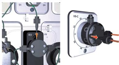
压力校正：System Control—System—Calibrate——选择对应的压力模块（可能有四种：Pre Column/Post Column/System Pressure/Sample pressure），校正前先把对应的压力传感器上的接头打开，让压力传感器和大气接触，然后点击 Calibrate，校正完成后接回管道。
