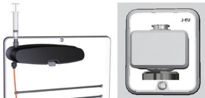
清洗紫外流路池：连接一个注射器在流路池上端，下端接废液口，可以用 1M NaOH 和水反复冲洗，观察纯水的紫外吸收是否在 1000mAu 以下，必要时还的需要用 10% 表面活性剂（如 Decon 90）和水反复冲洗。
