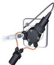
pH 计校正：System Control—System—Calibrate——选择 pH Monitor—Preparation for pH Calibration，两点校正，用注射器将校正液注入 pH 阀的矫正口，注意校正过程中不能拔掉注射器。读数稳定后点击 Calibrate，再换下一种校正液。校正完成后会自动报告校正成功或者失败。如果一直失败则考虑清洗 pH 电极，如清洗后没有改善，请考虑更换 pH 电极。
