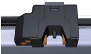
清洁收集器的 Sensor，位于 Avant 和 Pure 的 F9-C 收集器的臂上，图示中黄色部位。需要用柔软无尘纸巾擦干净。必要时可以用异丙醇擦拭。
