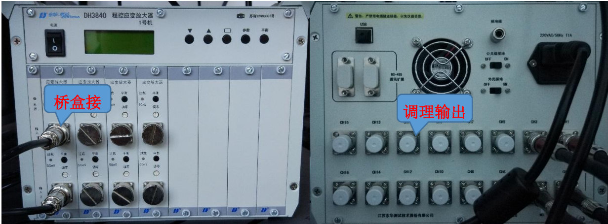
图 15:超动态应变仪输入输出图
