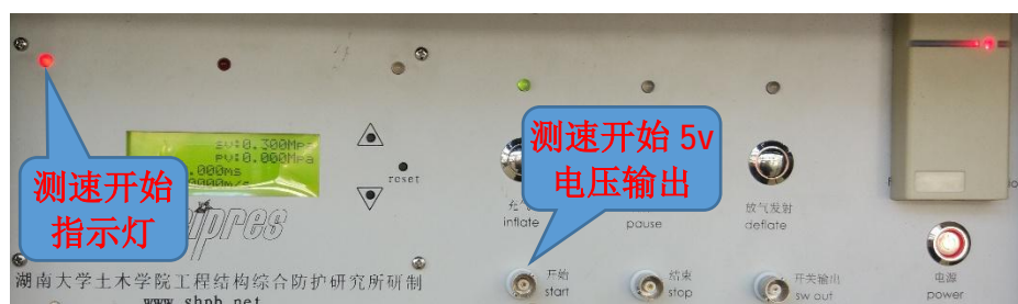
图 8:测速开始激光束被遮挡，开始指示灯亮起
